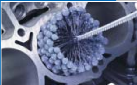
Oberflächenfinish einer Zylinderbohrung
